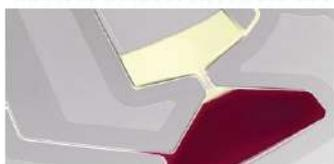
Separazione automatica del plasma integrata all'interno della cartuccia ViroTrack
